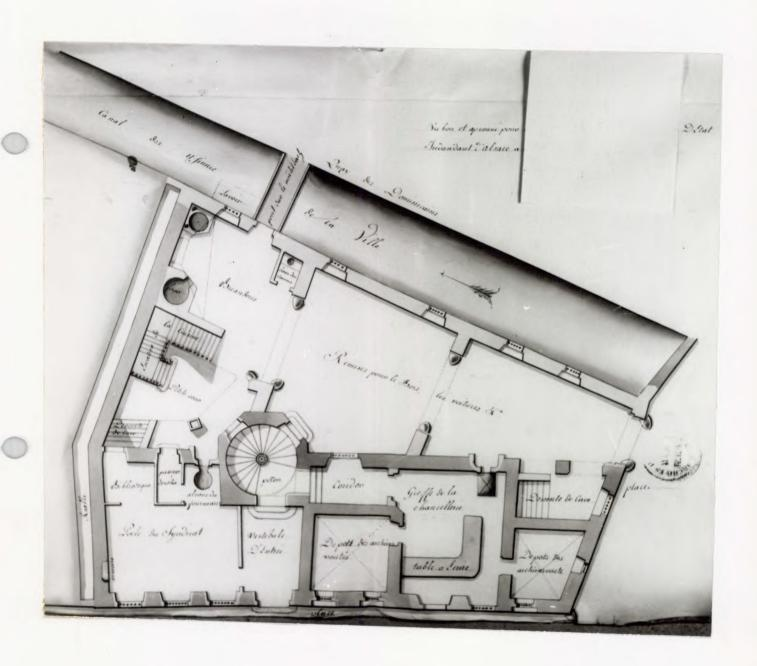
Premier projet : plan et distribution du rez-de-chaussée. (avec pan coupé). Plume et lavis. Ech. 250 x 300 mm.
