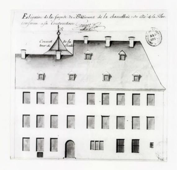
2e projet. Elévation sud sur la rue des Prêcheurs Plume et lavis. Ech. 250 x 300 mm. <u>Gouget</u> (signé). 1765. Elévation de la Façade du Côté du Canal conforme à sa construction.
